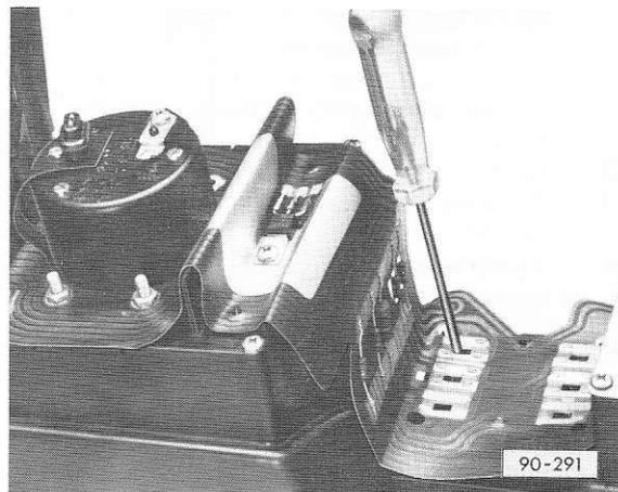
**Fig. 9 Reprise de l'ampoule dans le boîtier de témoins**
