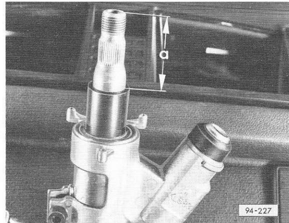
**Fig. 5 Réglage de l'écart entre le bord supérieur du manchon du tube de direction et la partie supérieure de la colonne de direction**
