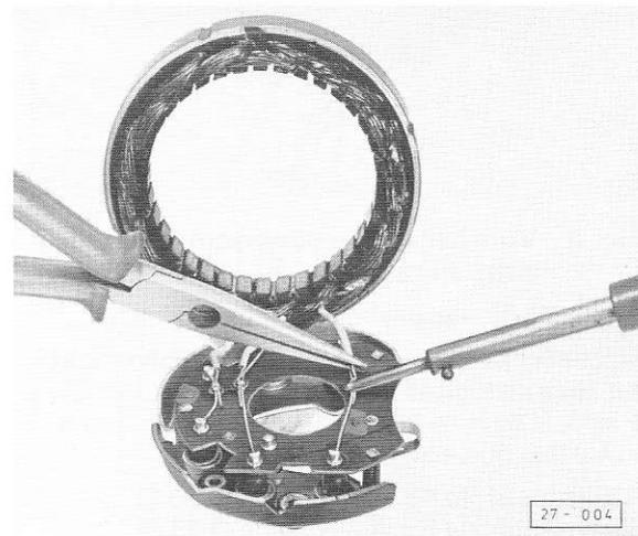
**Fig. 6** Dépose et repose du stator/plaque porte-diodes
