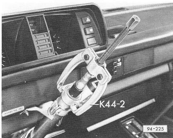
**Fig. 3 Dépose de l'antivol de direction**
